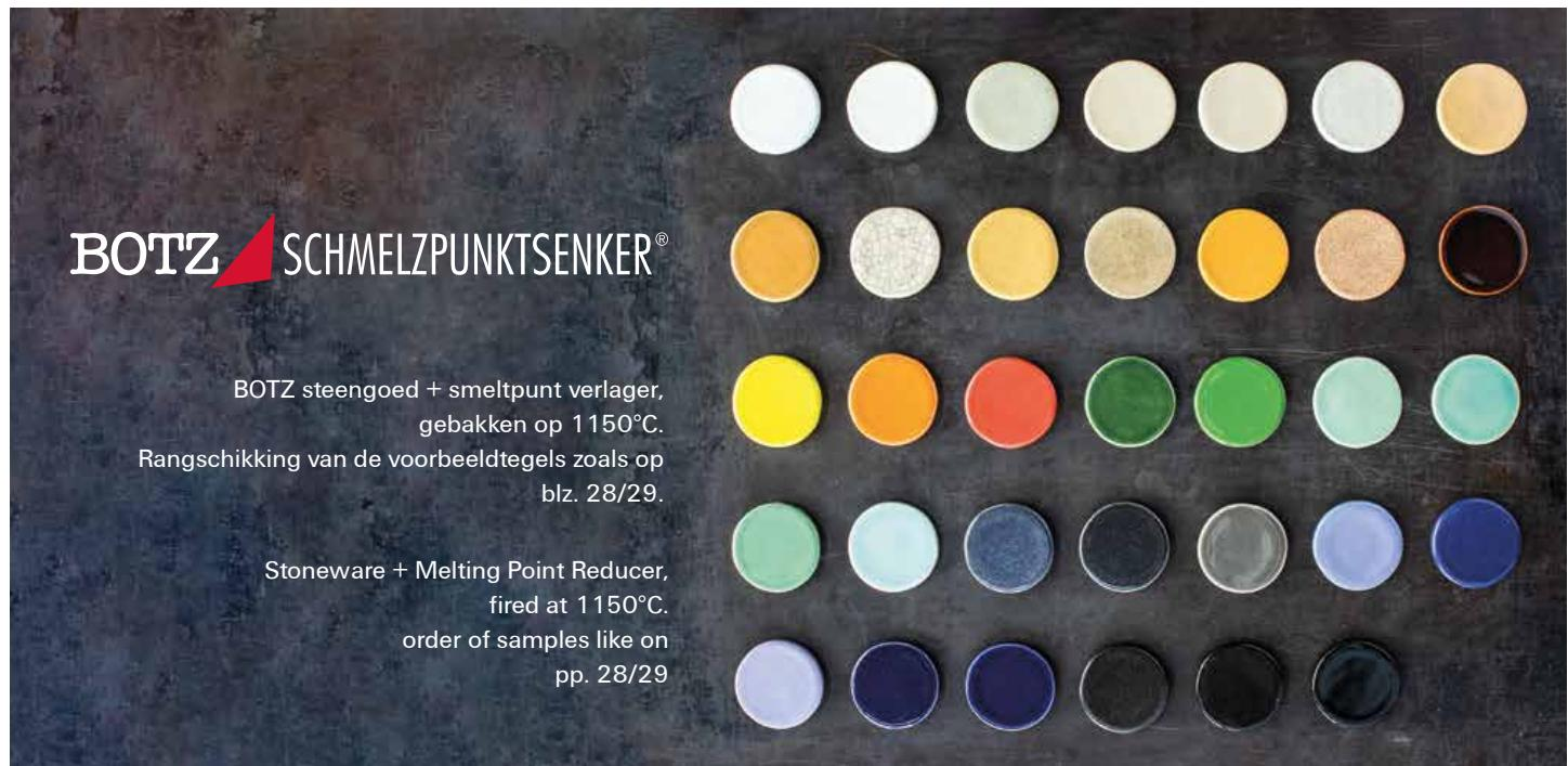
**BOTZ smeltpunt verlager 9800** kan aan BOTZ steengoed-glazuren toegevoegd worden, om het smeltpunt tot max. 1120°C te verlagen:
