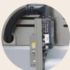
Veilige uitschakeling van de verwarming bij het openen van de kap
