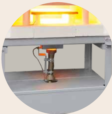
15 kW propaangasbrander gemonteerd onder de oven
