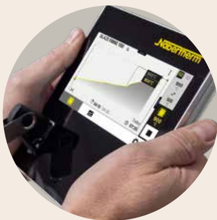
Controller met touchbediening AC590 (50 programma's met elk 40 segmenten)
